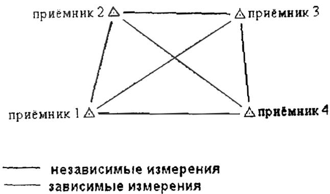
Рис. 2. Схема, иллюстрирующая проект независимого определения 3-х линий из сеанса, выполняемого на 4-х пунктах
