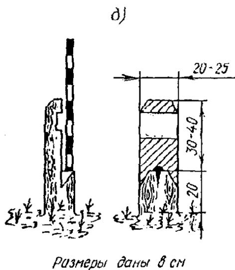
Рис. 4.1. Типы знаков долговременного закрепления пунктов съёмочного обоснования
